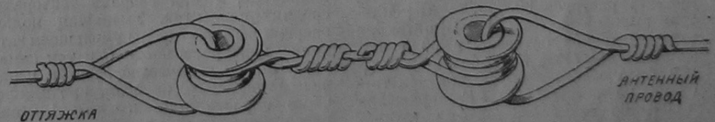
„Блочные“ изоляторы, применяемые московскими кружками.
